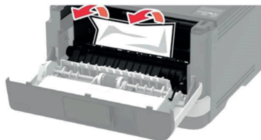
Рисунок 30 – Извлечение замятой бумаги.
