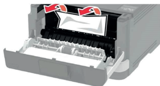
Рисунок 23 – Извлечение замятой бумаги из многоцелевого устройства подачи.
