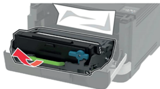
Рисунок 21 – Извлечение блока формирования изображения.
