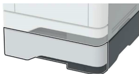
Рисунок 33 - Извлечение дополнительного лотка.
