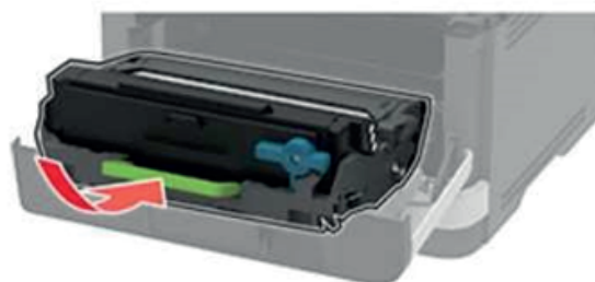
Рисунок 7 – Установка блока формирования изображения в принтер.
