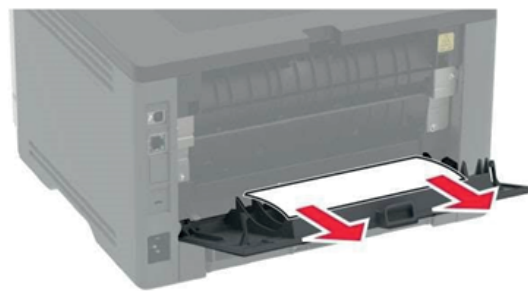
Рисунок 36 – Извлечение замятой бумаги.
