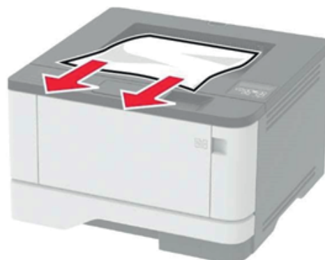
Рисунок 18 – Извлечение замятой бумаги в стандартном приемном лотке.
