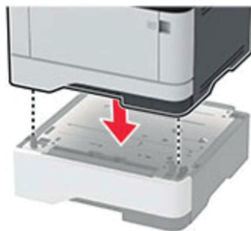
Рисунок 14 – Установка дополнительного лотка.
