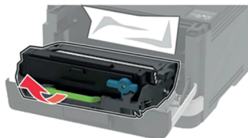
Рисунок 29 – Извлечение блока формирования изображения.
