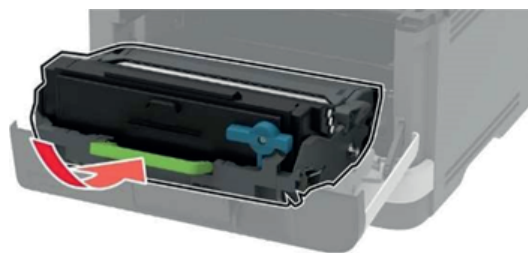
Рисунок 24 – Установка блока формирования изображения.
