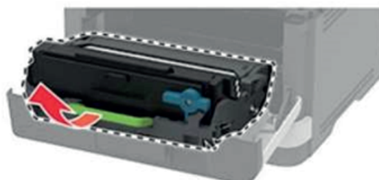
Рисунок 8 – Извлечение блока формирования изображения.
